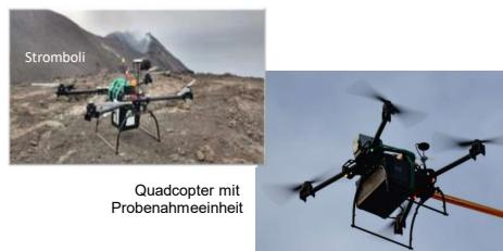
**Analytik:** Probenahme mit selektiven Reagenzien
