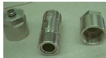
**Abb.** Auffangvorrichtungen für SF-Exktraktionen
