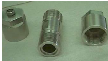
Abb. Extraktionszelle für die SFE
