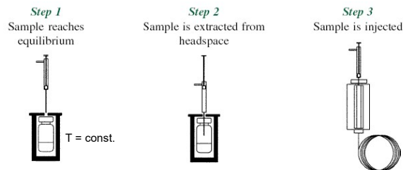
Abb. Vorgehensweise bei der statischen Headspace
