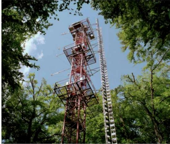
Um die Nettoemission an reaktiven biogenen flüchtigen organischen Verbindungen abschätzen zu können, wurden Freilandmessungen durchgeführt. Hier ein Blick auf den während des ECHO-Projektes Eingesetzten Messturm im Stettener Forst in Jülich. Die Messungen erfolgten höhenaufgelöst vom Boden bis oberhalb des Kronenraums.
