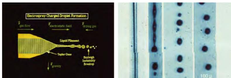
Abb. Schema zum ESI Prozess und Fotos des Zerfalls des liquid filaments (Bildung sog. varicose waves, Primärtropfenablösung, Auseinanderdriften der Primärtropfen durch Abstossung)
